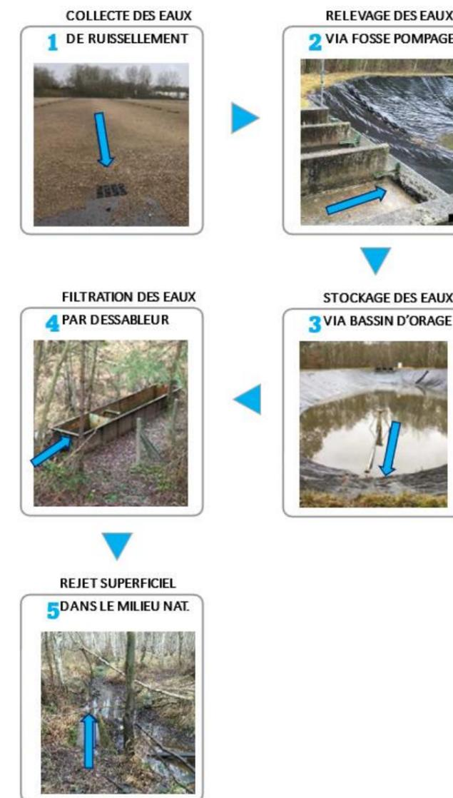
Figure 36 : Principe de fonctionnement des bassins d'orage (photographies issues de l'antenne du bassin Nord)
